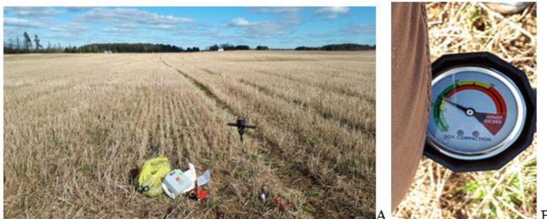
1.12.att. Augsnes agrofizikālomērījumu aprīkojums (A– instrumentu komplekts, B – penetrometrs).
