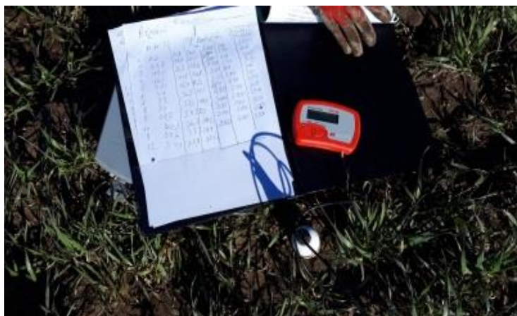
1.13. att. Augsnes mitruma noteikšanas mērinstruments (Moisture Meter version 2.1).
